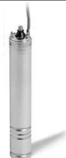
Motori sommersi asincroni a 2 poli lubrificati ad olio atossico, progettati per il funzionamento in pozzi da 3" o di diametro maggiore. I motori sono realizzati totalmente a norme NEMA. Possono lavorare sia in posizione verticale che orizzontale. Diametro massimo del motore: 73 mm.
