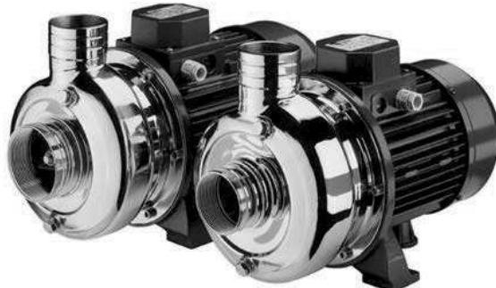
Pompe a girante aperta realizzate completamente in acciaio inox particolarmente indicate per usi domestici, agricoli ed industriali. Tutte le parti in contatto con il liquido pompato sono in acciaio inox Aisi 304 per garantire massima igiene e resistenza alla corrosione. La girante aperta consente alla pompa di pompare acqua pulita o relativamente sporca con parti solide in sospensione fino agli 8 mm.
