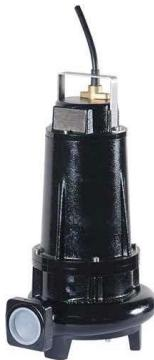
Pompe con girante tricanale ad innovativo sistema trituratore particolarmente adatte ad usi agricoli (macelli, stalle), ma che trovano impiego anche in scarichi civili ed industriali e reti fognarie. Il trituratore sminuzza i corpi solidi in sospensione, mentre respinge tutto il materiale che per dimensioni non può passare.
